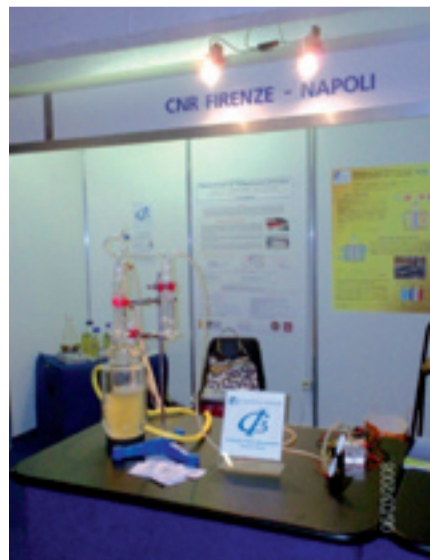
Figura 3. Prototipo di bioreattore per la produzione termofila di idrogeno. Sulla sinistra coltura contenente Thermotoga neapolitana cresciuta su glucosio (5g). Sulla destra è visibile una piccola elica mossa dalla corrente elettrica generata da una cellula a combustibile alimentata con bio-idrogeno prodotto dal batterio
