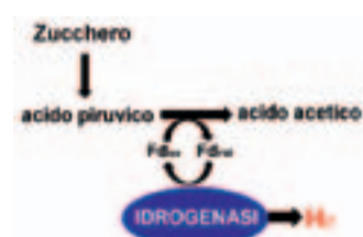
Figura 2. Schema semplificato per la produzione di idrogeno in estremofili della famiglia Thermotogales
